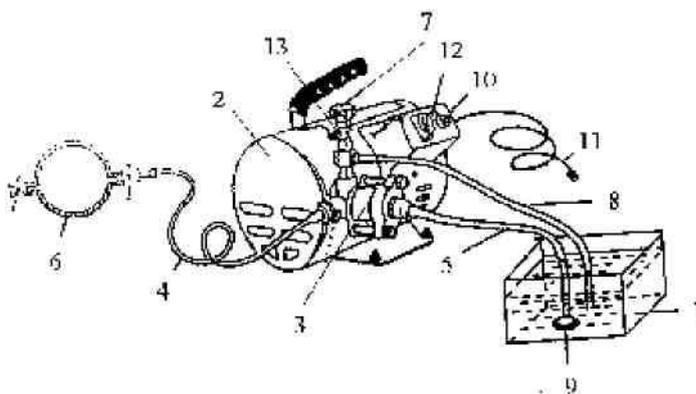
клапана давления 13, всасывающего шланга 5 с фильтром 9 и дренажного шланга 8. 4.2. Принцип работы насоса заключается в том, что электронасосом осуществляется всасывание рабочей жидкости из бака 1 и подача её на испытываемый объект 6 (по нагнетательному трубопроводу 4).
